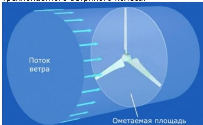
Рис.2 Ометаемая площадь для ветряного колеса с горизонтальной осью вращения.
